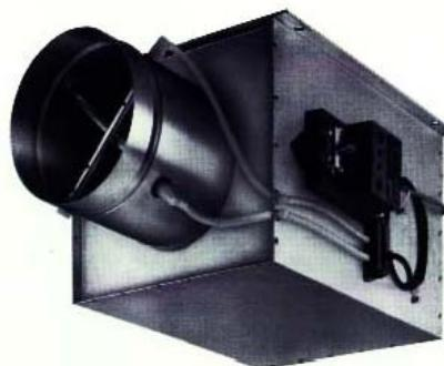
Hộp VAV Trox thích hợp cho việc điều khiển lưu lượng gió cấp trong hệ thống. Đầu vào có dạng tròn, đầu ra hình chữ nhật. Bộ điều khiển/chuyển đổi tính hiệu, mô-tơ được lắp bên ngoài vỏ hộp và được đấu nối, kiểm tra và cân chỉnh tại nhà máy Trox.
